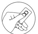
Caso el control remoto sea accionado mientras el portón esté abriendo, el automatizador se detendrá y quedará así hasta que el control remoto sea accionado nuevamente.
